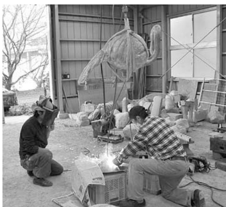
図12 脚部の接合部分の溶接作業の様子
