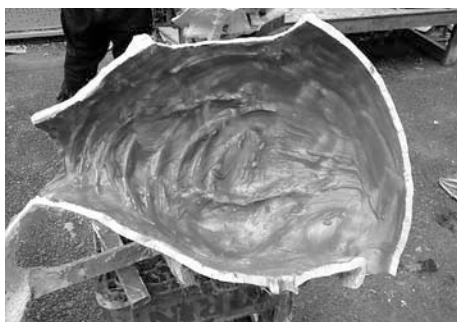
図9 FRP 樹脂一層目
