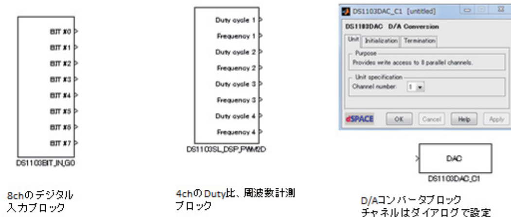
図 5.9 リアルタイム・シミュレータの作成に用いた RTI ブロック
