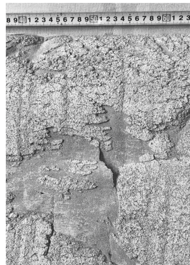
図8 ストラップ時に固着した漆喰
