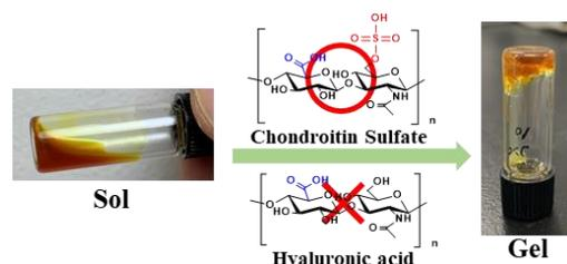
**Figure 4-2.** 硫酸化アニオン性多糖類の選択的な識別。
