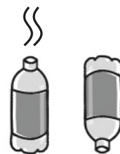
図-3 ペットボトルに入れたお湯を捨てたとき、ペットボトル内が大気圧（1気圧）であることを示す実験の概念図。
