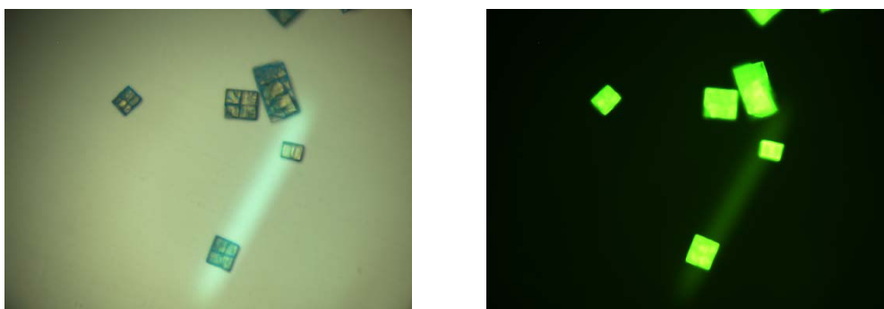
Fig.3.17 FA/ \gamma -CD =4 で合成した FA/CD-MOF
