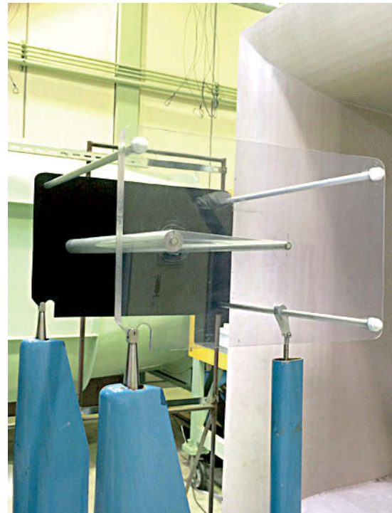
図2 空力天秤に取り付けた状態の供試模型 写真に示すように供試翼は、両側を挟み込んだ翼端板の前方2箇所、後方1箇所 で空力天秤のストラットへ固定されている。
