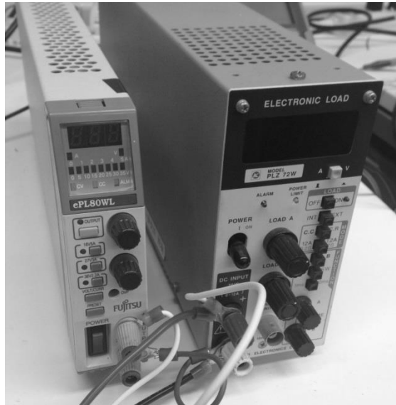
写真 2-3 バッテリー模擬のための接続の様子
