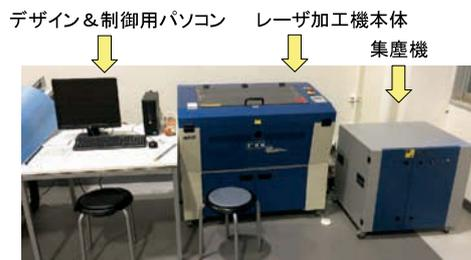
図1 炭酸ガスレーザー加工機
